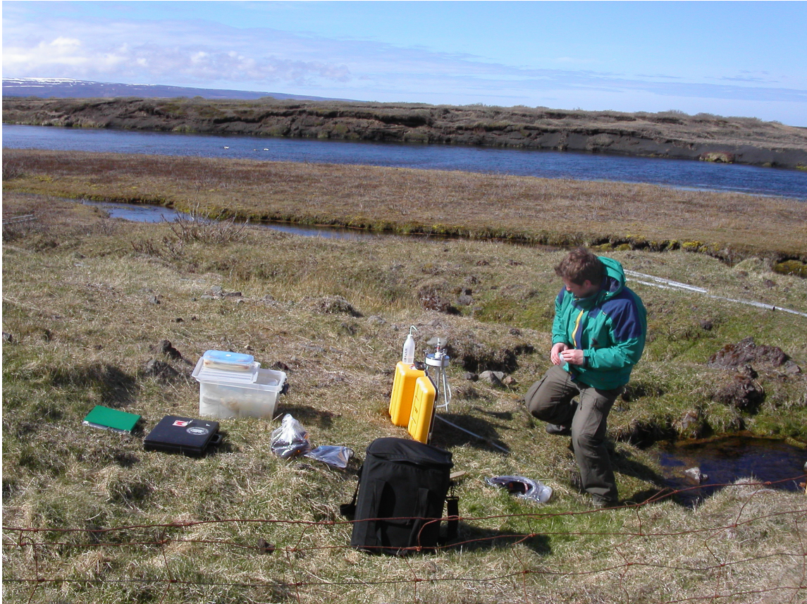
Mynd 7. Sýnataka á lindarvatni. Allur helsti búnaður sést á myndinni, dæla, síuhaldari ílát o.fl. Ljósmynd: Hrefna Kristmannsdóttir, 2007.
